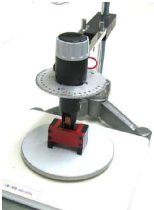
איור 6: תיאור המערכת הניסיונית לבדיקת ההשפעה של הזווית על הכוח המגנטי.
