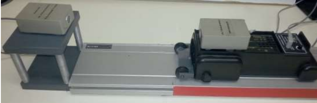
איור 7: המקלט על העגלה והמשדר בקצה המסילה.
